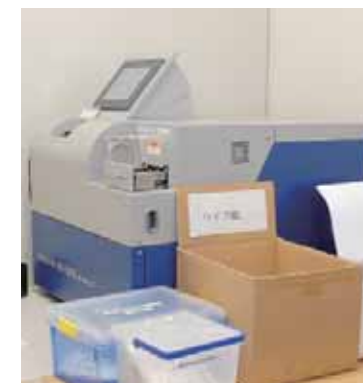
爆発物探知装置を事務所に設置し、輸出貨物のセキュリティにも万全に対応しています
